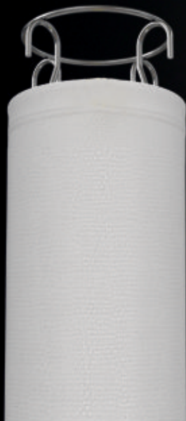
herkömmlicher Filterschlauch im aufgeblähten Zustand während der Abreinigung
